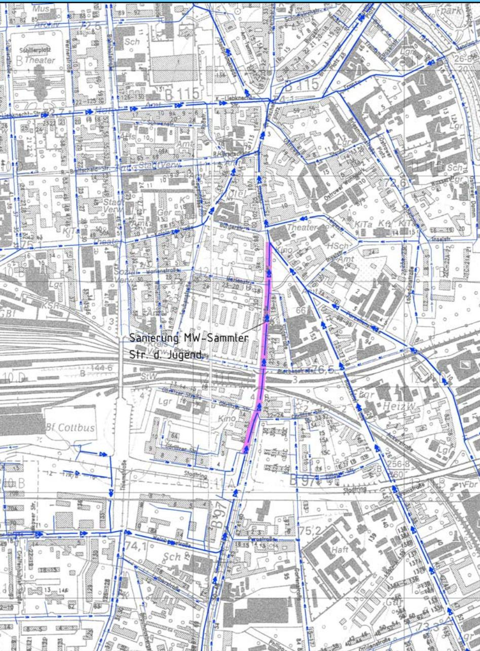
Der 1897 erbaute und nunmehr zu sanierende Mischwassersammler ist ein Hauptbestandteil des Cottbusser Entwässerungssystems. Das Schmutz- und Niederschlagswasser großer Teile der Spremberger Vorstadt sowie Sachsendorfs werden durch den Kanal zur Kläranlage einer Reinigung zugeführt.
